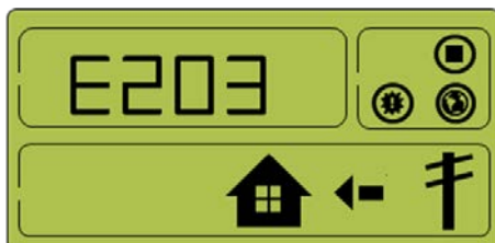
[Figura 4-22: Occorrenza di evento, evento di collegamento CC inverter in sequenza]
