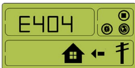
[Figura 4-31: Occorrenza di evento, errore di collegamento dei cavi PV]
