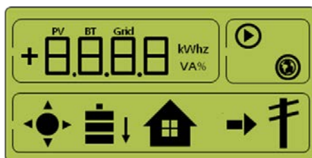
[Figura 4-2: Generazione PV, carica della batteria, utilizzo del carico, vendita della quantità rimanente]
