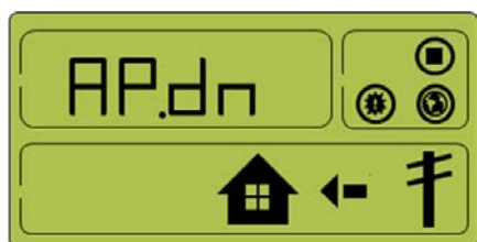
[Figura 4-35: Schermata di indicazione in modalità Download applicazione]
