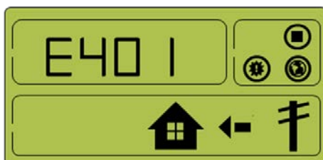
[Figura 4-28: Occorrenza di evento, protezione per sovratemperatura]
