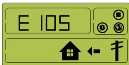
[Figura 4-16: Occorrenza di evento, protezione per sovratensione stringa PV 1]
