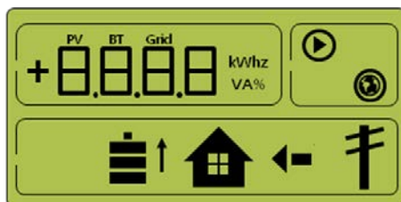
[Figura 4-8: Scarica della batteria, utilizzo del carico, acquisto della quantità mancante]
